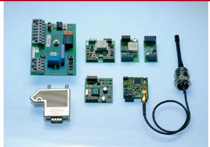
■ Die „Piggy Backs“ von SMA sind im Wechselrichter integriert. Sie kommunizieren mit dem externen Kontrollgerät. Bild: SMA Technologie AG
