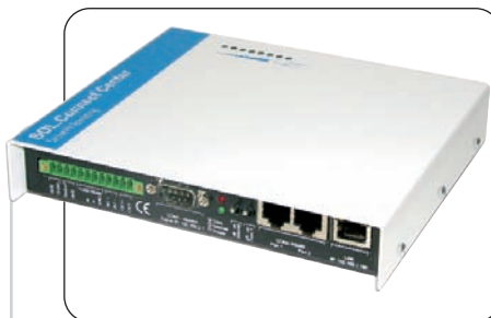
Bild 1: Die Erfassung von Umwelt- und Anlagendaten und deren Kommunikation erfolgt über das »SOL.Connect Center«
