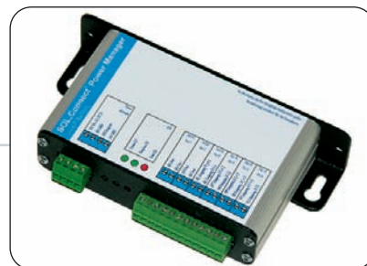
Bild 2: Die Anbindung des Rundsteuerempfängers an das Monitoringssystem erfolgt über den »SOL.Connect Power Manager«
